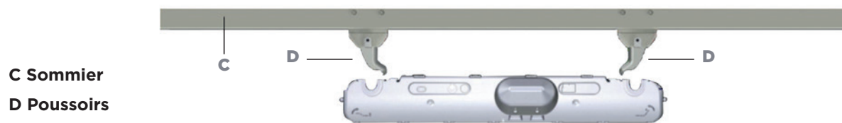
Figure 4. Installation du moteur
