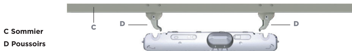
Figure 4. Installation du moteur
