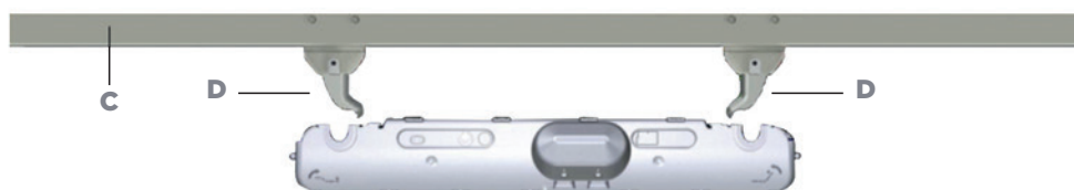
Figure 9. Installation du moteur
