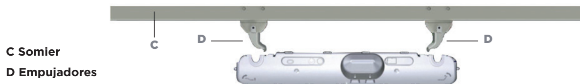
Figura 4. Instalación del motor
