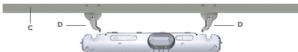
Figura 9. Instalación del motor
